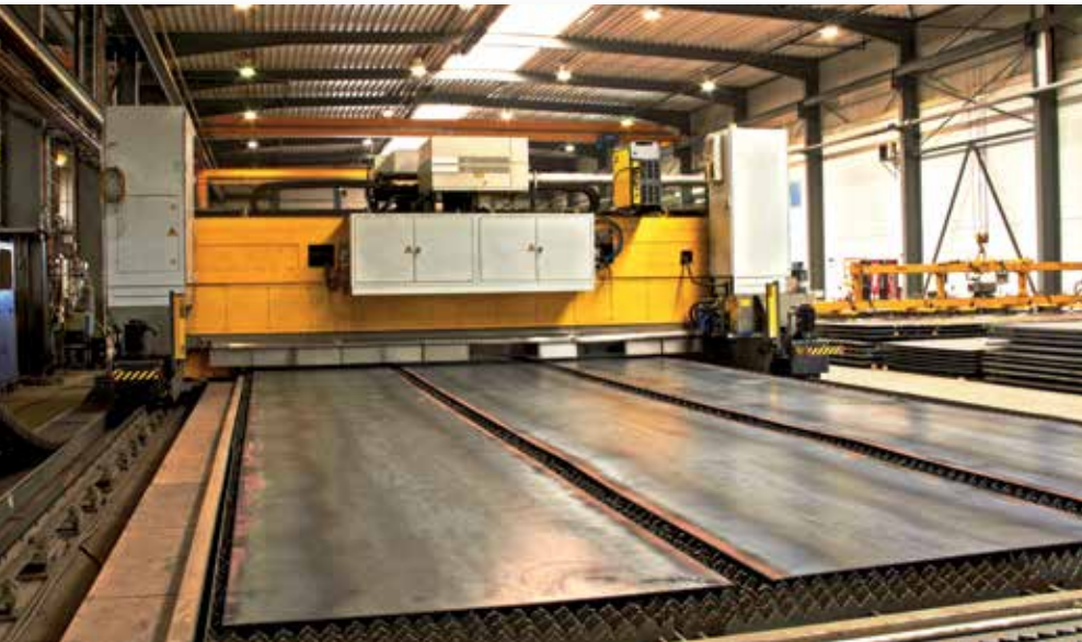
Stahl bis zu 40mm Stärke schneiden wir mit modernster Plasma und Laser-Technologie
